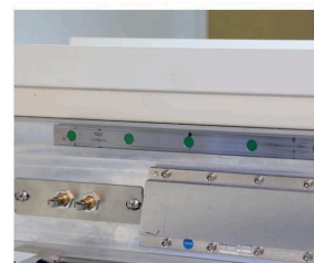
日本THK直线导轨 Japan THK linear guide rail
